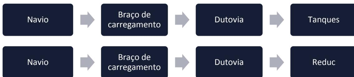
Figura 76 – Fluxogramas do desembarque de derivados de petróleo (exceto GLP) no Terminal Aquaviário da Ilha d'Água
