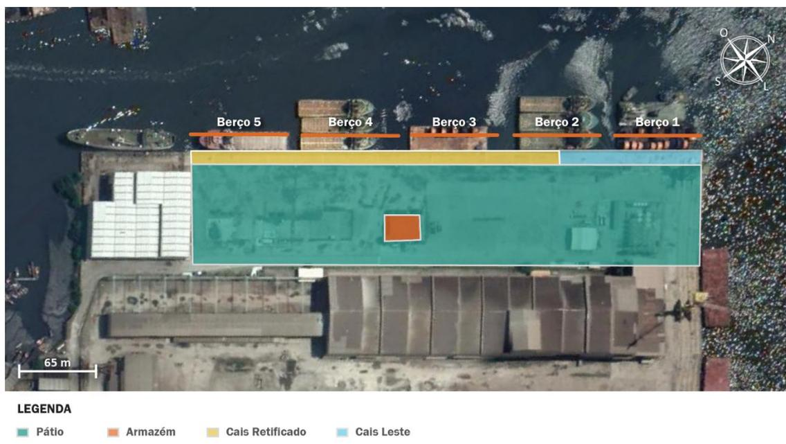
Figura 65 – Infraestrutura de armazenagem e acostagem do TUP Briclog
