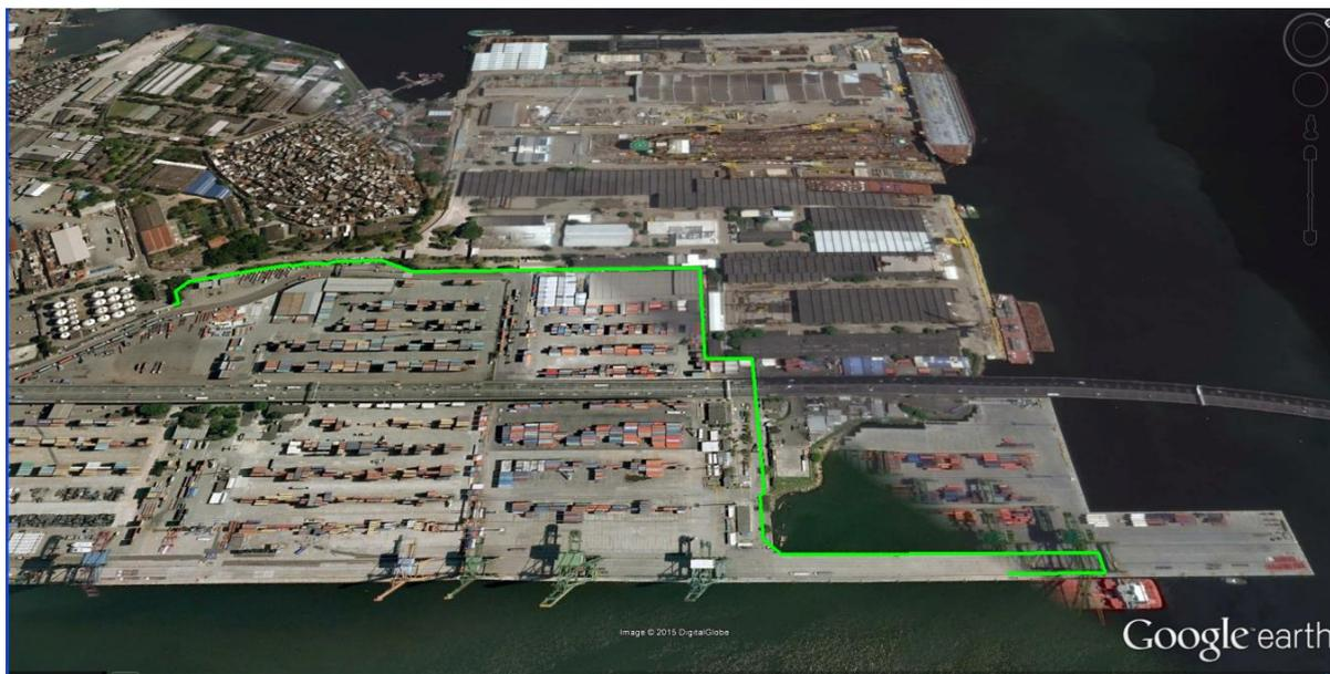
**Figura 178 – Dutovia do Terminal de Granéis Líquidos do Caju**
