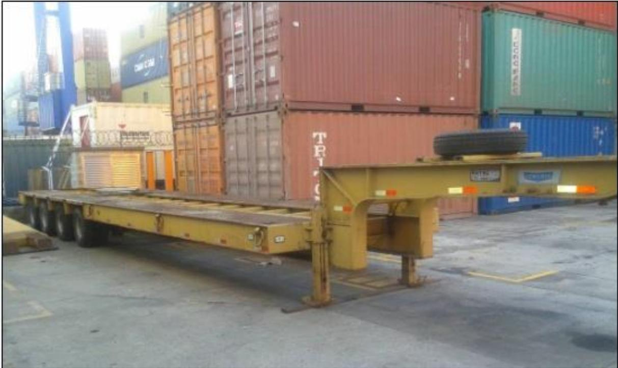
**Figura 28 – Semirreboque tipo prancha 43,5 ton.**
